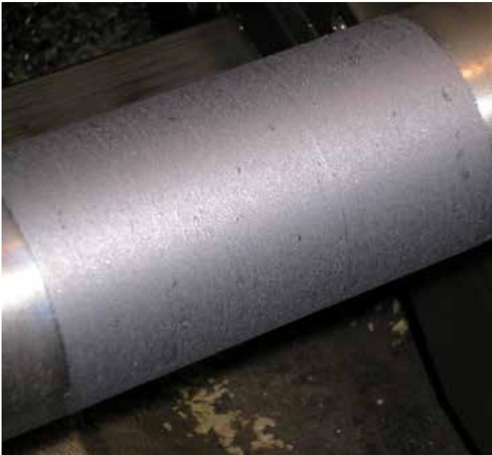
Belzona 1131 (Bearing Metal) es un sistema de reparación en pasta, con un contenido del 100 % de sólidos y propiedades autolubricantes, diseñado para la creación de superficies con bajo nivel de fricción que se someterán a contacto intermitente y cargas específicas bajas.
