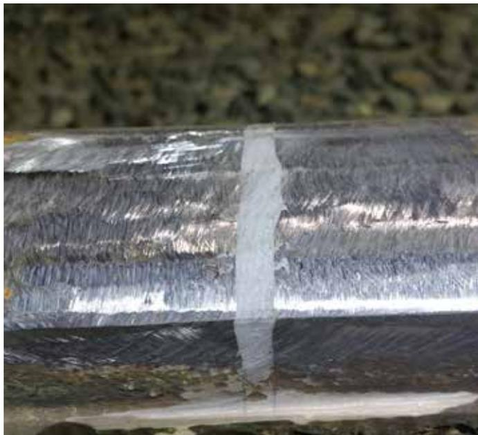
Belzona 1221 (Super E-Metal) es un compuesto de reparación de emergencia de dos componentes basado en un sistema polimérico reforzado con acero y cerámica. Este producto Belzona totalmente mecanizable se puede utilizar para la reparación, la reconstrucción o la soldadura permanente de componentes metálicos.
