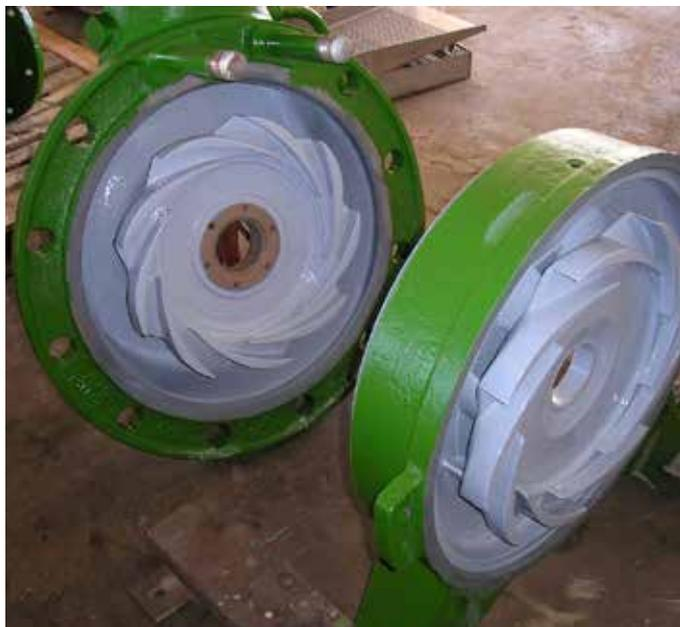
Belzona 1341N (Supermetaglidle) es un sistema de recubrimiento de dos componentes diseñado para mejorar la eficiencia de los equipos de manejo de líquidos y proteger los metales de los efectos de la erosión y la corrosión.
