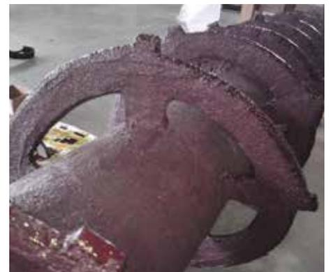
Transportador sinfín recubierto con Belzona 1811
