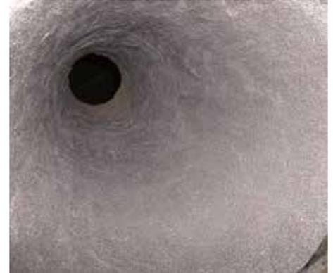
Cono de acero recubierto con Belzona 1812
