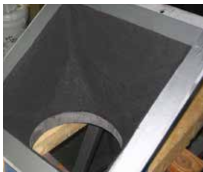
Protección para canales de descarga y tolvas
