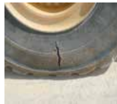
Reparación de rasgadura y grieta
