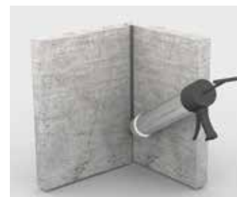
Sellador de juntas de expansión en paredes adyacentes
