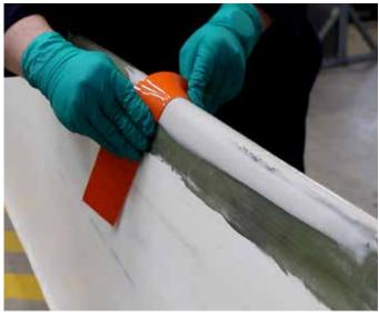
Permite contornear fácilmente el borde delantero, no requiere de lijado.
