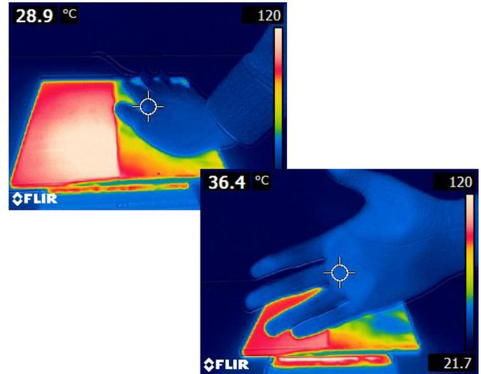
Puede observarse cómo una capa única de Belzona 5871 reduce la transferencia de calor y evita quemaduras térmicas
