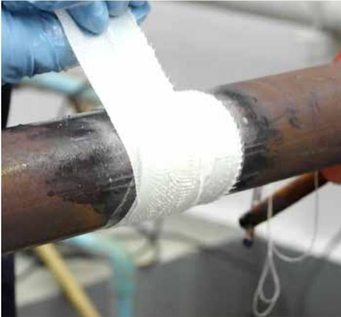
Belzona 9631 es un kit de sellado de fugas que contiene una envoltura de fibra de vidrio de 5 cm x 150 cm que ya viene impregnada y se activa con agua. La envoltura viene envasada en un sobre de aluminio herméticamente sellado, está lista para usar y no requiere mediciones ni mezclas.
