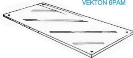
placas de desgaste VEKTON 6PAM
